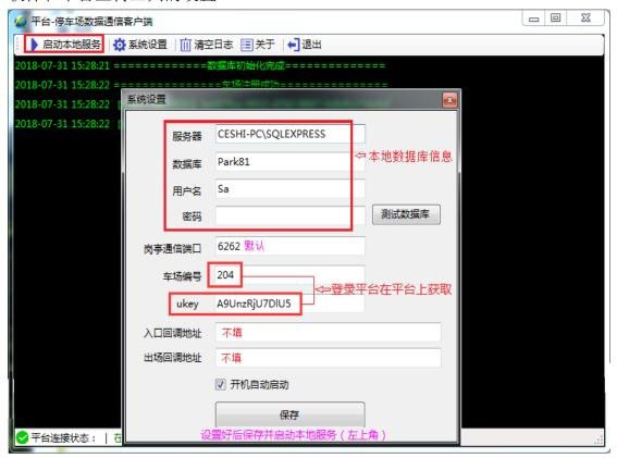
上传工具上面是连接软件使用的数据库,右边可以测试上传工具连接数据库是否正常。端口号默认是 6262。车场编号和 ukey 可以登录云平台车场账号和密码里面查看
