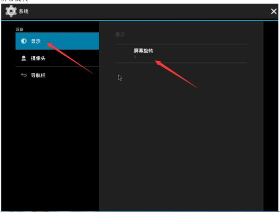
当屏幕显示不对的时候可以将屏幕旋转90度
